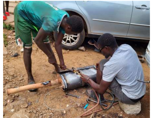
Auspufftopf kaputt? Kein Problem! Es wird einfach ein Stück Blech ausgestanzt, drumherum gewickelt und verschweißt. Hält aber nicht lange.
